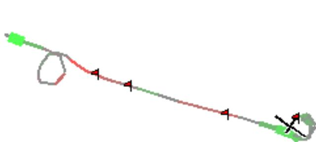
Si un Vega ou un autre variomètre intelligent est connecté avec un sortie "Netto", la valeur du vario Netto est utilisée. Alors la couleur et l'épaisseur de la trace sol représentent la vitesse verticale de la masse d'air à la place de celle du planeur.
