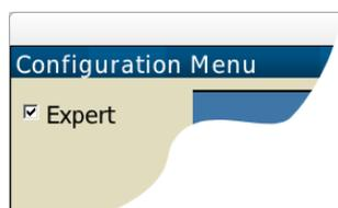
A janela de configuração principal (Ajuste do sistema) pode rodar em nível Básico ou Avançado através de um campo no canto superior esquerdo da janela. Quando está no modo Básico, alguns ajustes menos usados (ou mais avançados) são ocultados. Nas descrições abaixo, todos os parâmetros marcados com asterisco estão visíveis somente no modo avançado.
