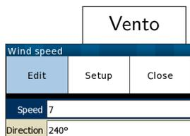
O vetor de vento estimado pelo XCSoar. O ajuste manual é possível e está conectado com a janela e a infobox. Apertando o cursor acima/abaixo irá através dos ajustes e para ajustar os valores, tecler direita/esquerda.
