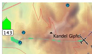
En montée dans les thermiques, des marques sont créées automatiquement et affichées à l'écran. La position des 20 derniers thermiques est stockée jusqu'à la fin du vol. Cette historique des thermiques est accessible par la fonction "Qu'y-a-t'il ici?", de la même façon que les autres marques et les points de virage.
