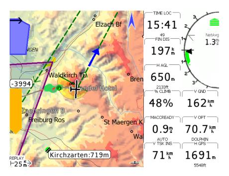
Rysunek 3.1: Typical XCSoar main screen layout
