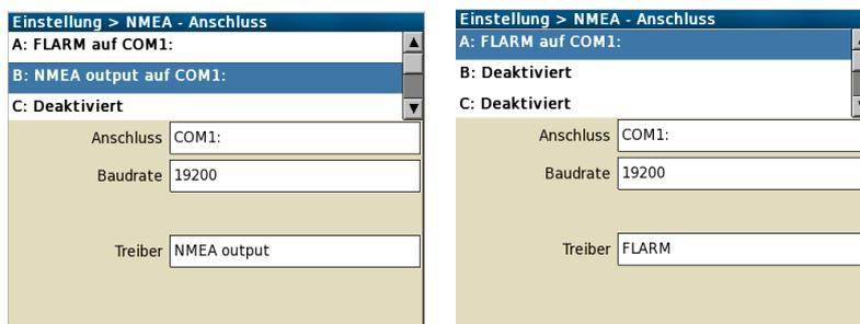
Auf diese Art und Weise werden beide Geräte mit den identischen Daten versorgt, so, als ob sie direkt vom Flarm, VEGA, o.ä. kämen. Auf gleiche Weise können zwei Altair mit identischen Daten versorgt werden, wenn nur eine Datenquelle zur Verfügung steht.
