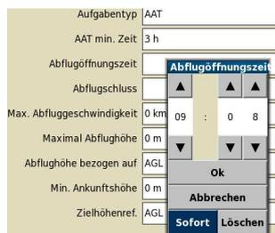
"Abflug - geöffnet/geschlossen Countdown": Zeit als Countdown die Dauer bis zur Eröffnung des Abflugfensters an, anschließend die Dauer des Abflugfensters bis zum Schließen desselben.
