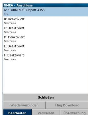
Der Button Wiederverbinden dient dazu, das gerät mit XCSoarneue wiederzuverbinden. Dies geschieht normalerweise automatisch, aber in manchen Fällen kann es sinnvoll sein, dies manuell zu versuchen - bspw. Fehlersuche...
