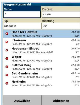
Wenn die Filterung nach Namen und gilt gewählt wird, ist die Ergebnisliste nach dem Namen geordnet. Wenn (auch zusätzlich) die Wegpunkte nach Entfernung oder Richtung gefiltert werden, dann erfolgt die Sortierung der Wegpunkte grundsätzlich als erstes nach der Entfernung. D.h., der als nächste gefundene Wegpunkt wird immer an die Spitze der Liste gesetzt.
