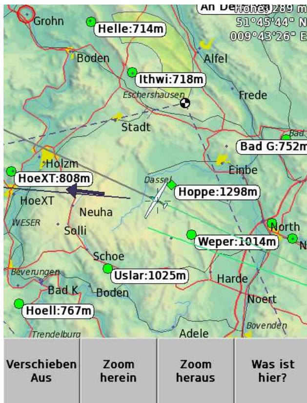
Mit der Auswahl von **Was ist hier** öffnet sich ein Menü, welches entsprechende Kartenelemente wie z.B. Wegpunkte und Lufträume die sich in der Nähe des Fadenkreuzes befinden, sowie die eigene Position anzeigt und zur Auswahl/Bearbeitung darstellt. Zu den jeweiligen angezeigten Elementen werden Entfernung und ggf. benötigte Höhe angezeigt.
