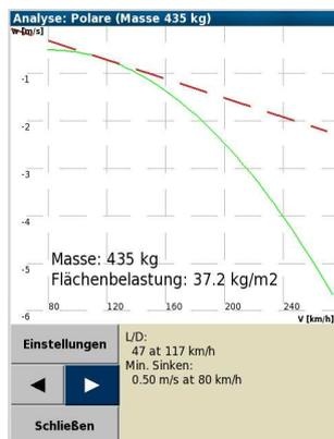
Die Polare-Seite zeigt einen Graphen der Polare mit den aktuellen Mücken und Ballast-Einstellungen. Weiterhin ist das beste Gleiten und die dementsprechende Geschwindigkeit abzulesen, sowie das minimale Sinken und die dementsprechende Geschwindigkeit. Das vorher eingestellte Startgewicht ist ebenfalls hier abzulesen.
