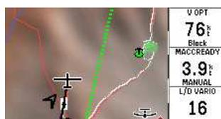
Dies bedeutet, daß XCSoarsich die Position der Thermikquelle intern über Grund merkt. Mit anderen Worten, wenn Du einen Bart ganz oben verläßt, und später zu diesem in tieferen Höhen zurückkehrst wird die angezeigte Position auf der Karte die Position in der entsprechenden Höhe sein (welche etwas luvwärts stehen wird als die Basis.)
