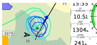
Durch einen Algorithmus wird der Kern der Thermik errechnet und dargestellt. Das Symbol für das Zentrum ist eine kleine grüne Spirale auf der Karte der moving map. Der Thermikfinder markiert *fortlaufend die letzten 20 Bärte* während des Fluges auf der Karte. Die Position des Zentrum kann mit der Abdrift durch den ermittelten Wind korrigiert werden.
