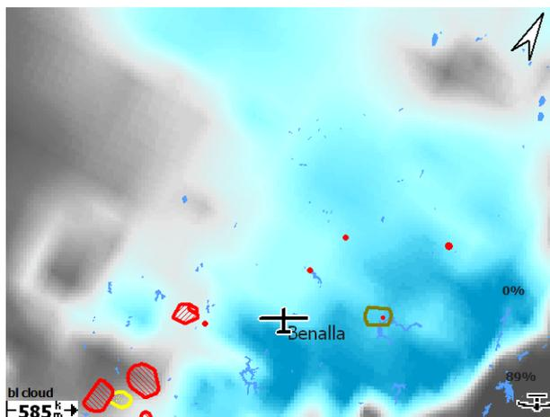
Sfc temp : Temperatur in 2m Höhe über Grund. Vergleicht man diese vorhergesagte Temperatur mit der tatsächlich gemessenen Temperatur erhält man ein grobes Maß zur Abschätzung der Genauigkeit des Vorhersagemodelles.
