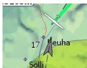
Windrichtung und -stärke werden kontinuierlich auf der Karte dargestellt. Die Länge des Pfeiles steht für die Stärke des Windes, eine Textdarstellung erfolgt ebenfalls in unmittelbarer Nähe der Pfeilspitze.
