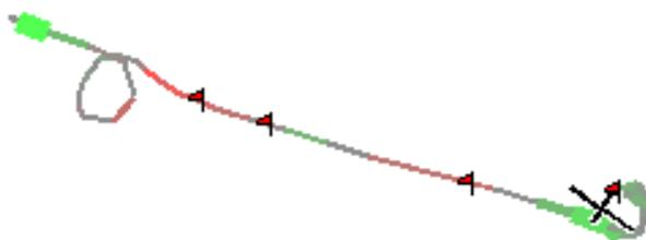
Wenn ein VEGA-Variometer angeschlossen ist und die Netto-Luftmassenbewegung anzeigt, dann können die Farben und Dicken dieser Spur auch die Netto-Luftmassenbewegung darstellen.
