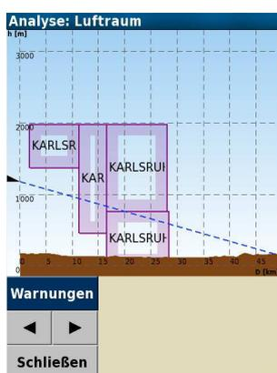
*Luftraum* : Eine Übersicht über die im Task über- unter, oder durchflogenen Lufträume wird als Grafik über der Zeitachse dargestellt. Lufträume sind als Markierungen mit seitlicher und oberer Höhe dargestellt.
