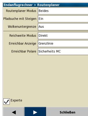
**Pfadsuche mit Steigen\*** : **Ein / Aus**: Wenn dies aktiviert und MC größer Null, dann erlaubt der Routenplaner Steigphasen zwischen der aktuellen Position und dem Ziel.
