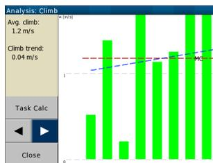
*Steigen* : Zeigt den Verlauf der bisher erfolgten Bärte. Diese Statistik kann benutzt werden, um z.B. den Schnitt aller Bärte des Tages herauszufinden, oder wie sich die Entwicklung über den Verlauf des Fluges änderte.
