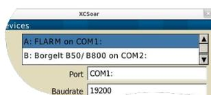
A página de dispositivos é usada para especificar as portas usadas para comunicar o GPS com outros dispositivos seriais. Os ajustes padrões são COM1 e 4800 bits por segundo. Quando conectado com o variômetro inteligente Vega, os ajustes deverão ser COM1 e 38.400.
