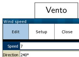
O vetor de vento estimado pelo XCSoar. O ajuste manual é possível e está conectado com a janela e a infobox. Apertando o cursor acima/abaixo irá através dos ajustes e para ajustar os valores, tecla direita/esquerda.
