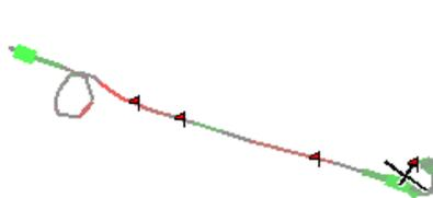
Se houver conexão do Vega ou outro variômetro inteligente com a saída Netto, o valor do vário Netto é usado; conseqüentemente as cores e a espessura do rastro indicarão o movimento vertical da massa de ar ao invés do movimento vertical da aeronave.
