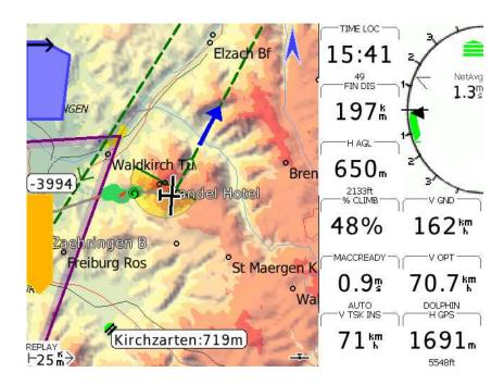
Rysunek 3.1: Typical XCSoar main screen layout
