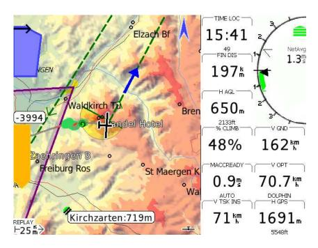
Rysunek 3.1: Typical XCSoar main screen layout
