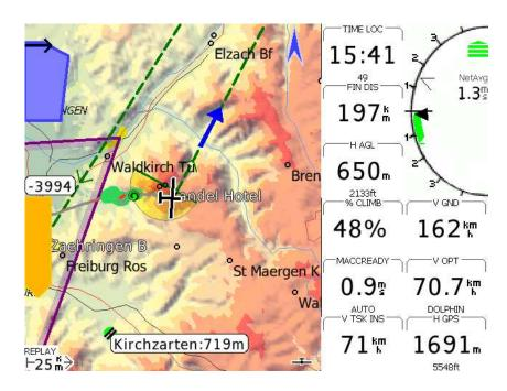
Rysunek 3.1: Typical XCSoar main screen layout
