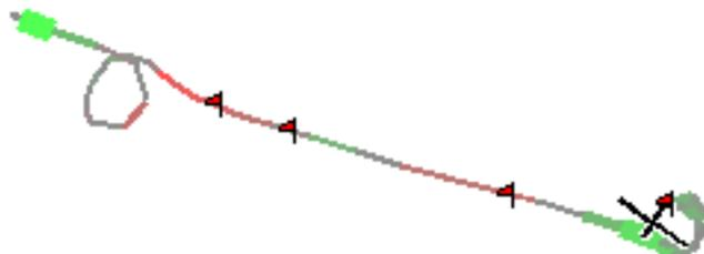
Si un Vega ou un vario "intelligent" est connecté avec un sortie "Netto", la valeur Netto est utilisée. Alors la couleur et l'épaisseur de la trace sol représente la vitesse verticale de la masse d'air à la place de celle du planeur.
