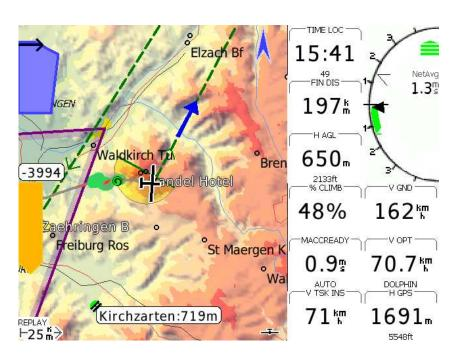
Rysunek 3.1: Typical XCSoar main screen layout
